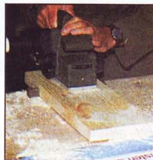
Крупногабаритные заготовки обрабатывают последовательно отдельными участками.
