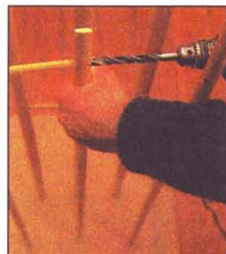
В закреплённых клеём стойках сверлят отверстия для поперечин.
