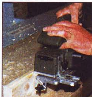
Для выборки электрорубанком фальца на заготовке требуется параллельный упор.
