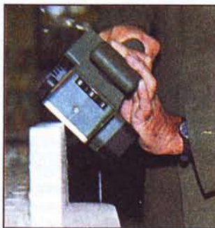
При снятии фаски направляющей служит паз в передней части подошвы рубанка.
