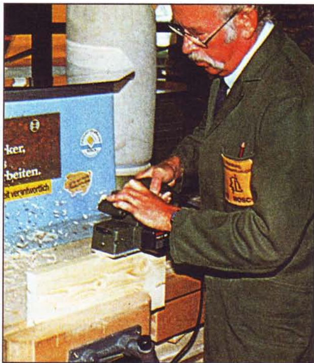
Стоя сбоку и чуть сзади от заготовки, проводят рубанок по возможности одним равномерным движением рук по обрабатываемой поверхности.
